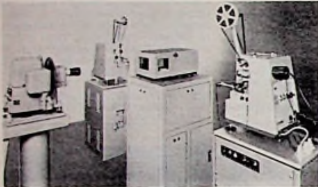
De foto van afb. 1 toont de opstelling van het geheel, met in het midden de multiplexer en de camerakast.
